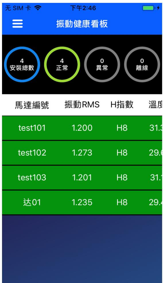
如圖所示，上半部分顯示 VB-168 設備的安裝總數，VB-168 設備的正常個數，VB-168 設備的異常個數，VB-168 設備的離線個數，下半部分顯示每個 VB-168 設備的資訊，包括編號，振動 RMS，H 指數，溫度，電量，時間，以及狀態，如紅色表示告警狀態，黃色表示預警狀態，綠色表示正常狀態，灰色表示離線狀態，發生告警的 VB-168，會將其置頂展示，這個頁面的資料，每 3 秒刷新一次，點擊單個 VB-168 設備，進入該 VB-168 的振動、溫度量測頁面。
