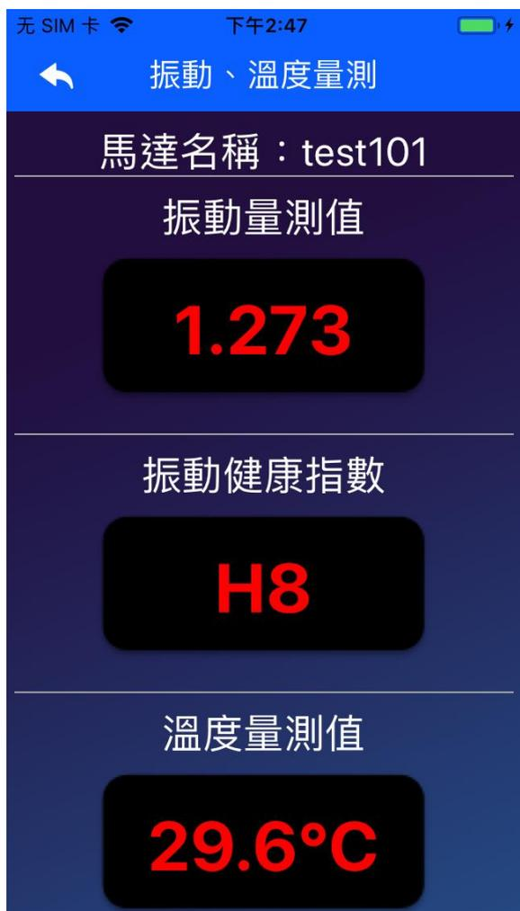
如上圖所示顯示單個 VB-168 的振動、溫度量測等資料，每 3 秒刷新一次。
